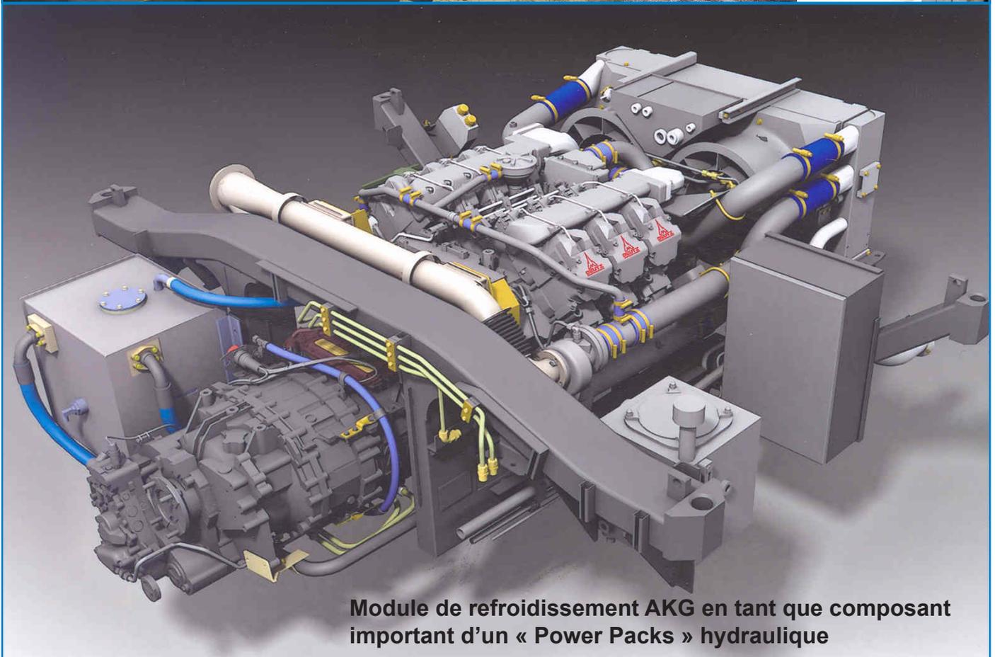
Module de refroidissement AKG en tant que composant important d'un « Power Packs » hydraulique
