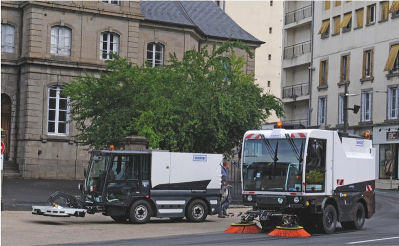
Der Aebi Schmidt Cleango 500 ist eine Kompaktkehrmaschine von der Firma Aebi Schmidt. Der Cleango wird zur Reinigung von Straßen in Städten und Industriegebieten eingesetzt und besitzt ein unter der Fahrerkabine gesetztes Tellerbesenystem. Das eingesetzte Kühlmodul ist speziell für Reinigungsfahrzeuge entwickelt um eine perfekte Kühlleistung zu garantieren.
