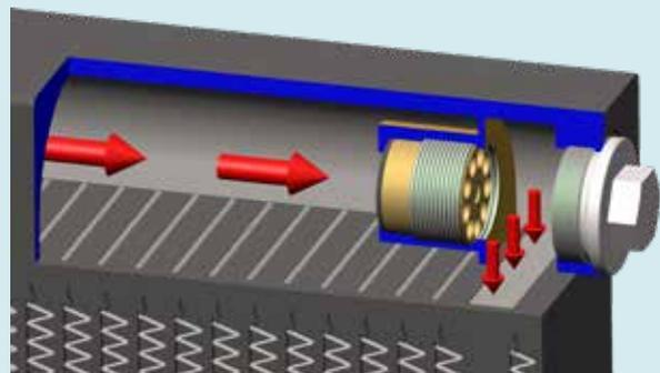
Auf eine aufwendige Installation eines externen Bypasses kann verzichtet werden, was Kosten und Einbauraum reduziert.
